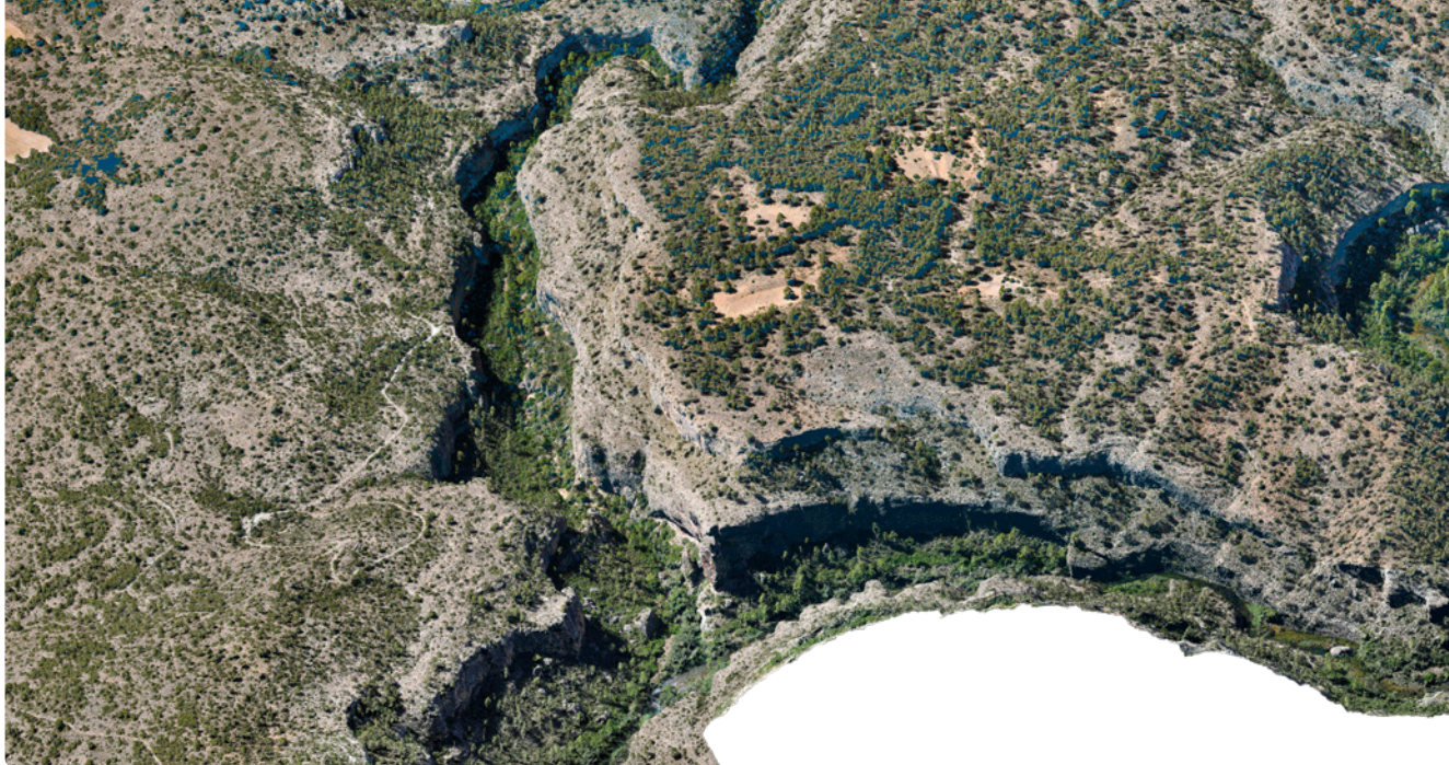
Nube de puntos densa obtenida con un vuelo de dron de ala fija de la zona de desembocadura de la Hoz de Vicente en el río Cabriel
